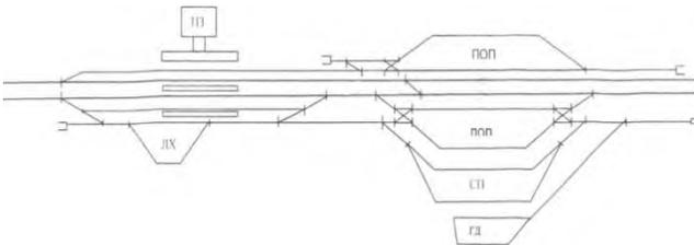
№ 8 Разработать схему развязок подходов с 4 направлений к пассажирской и сортировочной станциям, расположенным в узле параллельно друг другу последовательно.
