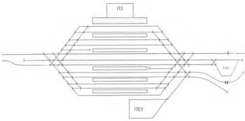
№10 Обоснуйте наиболее рациональное расположение ЛХ и ходовых путей для локомотивов на схеме односторонней сортировочной станции с последовательным расположением парков, добавьте пропущенные соединения.
