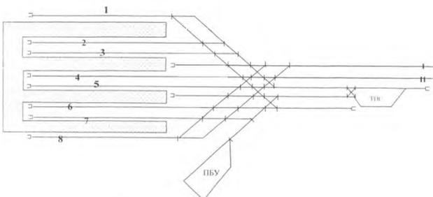
№14. Завершите разработку объединенного парка приема односторонней сортировочной станции
