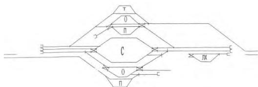
№3. Обоснуйте наиболее целесообразное расположение ЛХ и ходовых путей на односторонней сортировочной станции с комбинированным расположением парков. добавьте пропущенные соединения и устройства
