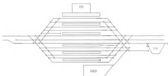
№2. Завершите разработку схемы односторонней сортировочной станции с параллельным расположением парков, добавьте пропущенные соединения и устройства
