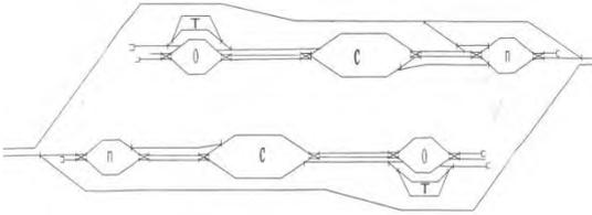
№5. Завершите разработку односторонней сортировочной станции с комбинированным расположением парков, добавьте пропущенные соединения и устройства
