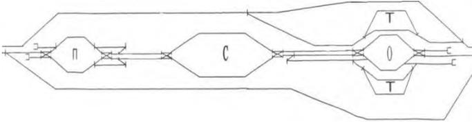
№11. Завершите разработку схемы односторонней сортировочной станции с последовательным расположением парков, добавьте пропущенные соединения и устройства.
